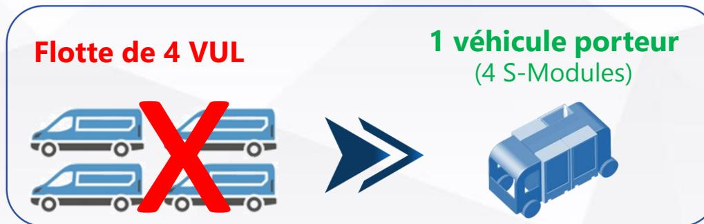
N.B: L'équivalence en VUL diesel (typiquement les « camionnettes blanches » des locataires) est faite sur le contenu d'une tournée moyenne de 120 positions, livrées en porte à porte. Un S-Module® est capable d'emporter 135 colis d'une moyenne de 3 kg à 90% de remplissage. Par prudence, on simplifie en considérant 1 S-Module® pour 1 VUL diesel.
